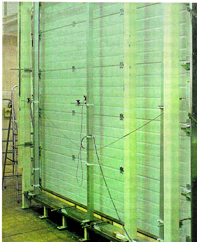
Kapu légzárási, vízzárási és szálállósági vizsgálata
