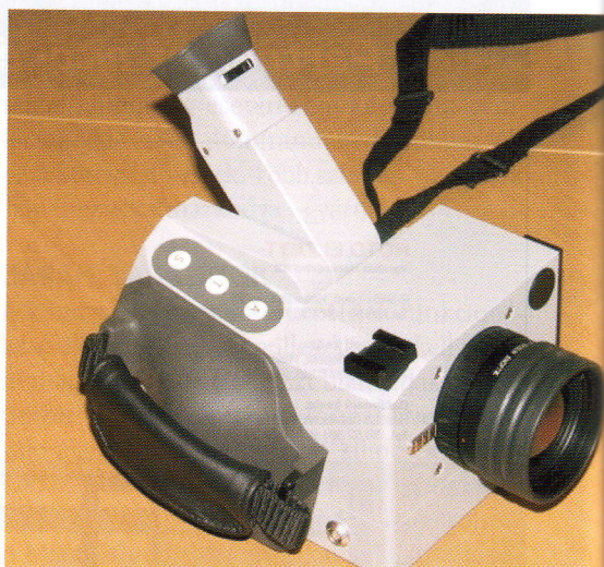
Korszerű diagnosztikai hőkamera épületvizsgálatokhoz
