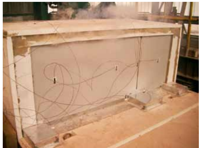
FÜGGÖNYFAL TÖMÖR MEZŐJÉNEK (RÉSZLEGES KONFIGURÁCIÓ) TŰZÁLLÓSÁGI VIZSGÁLATA
