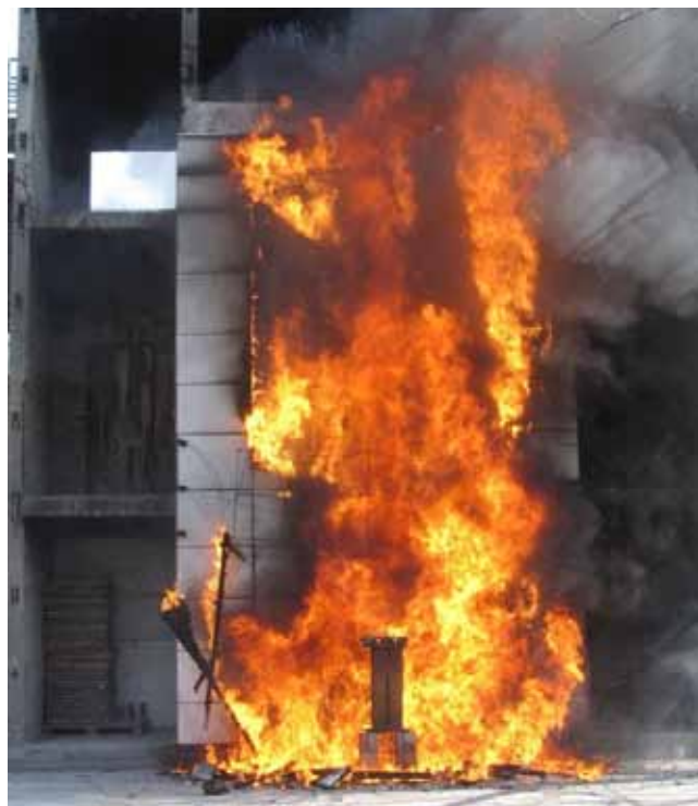
ÁTSZELLŐZTETETT HOMLOKZATBURKOLAT HOMLOKZATI TŰZTERJEDÉSI VIZSGÁLATA
