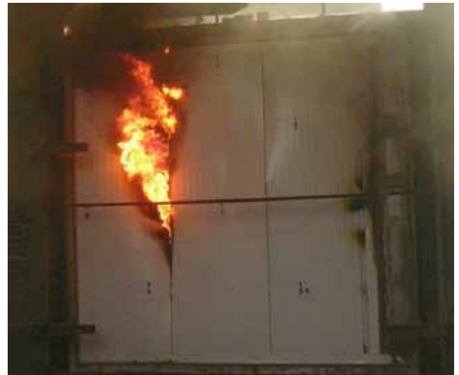
NYÍLÁS NÉLKÜLI SZENDVICSPANEL-FAL TŰZÁLLÓSÁGI VIZSGÁLATA
