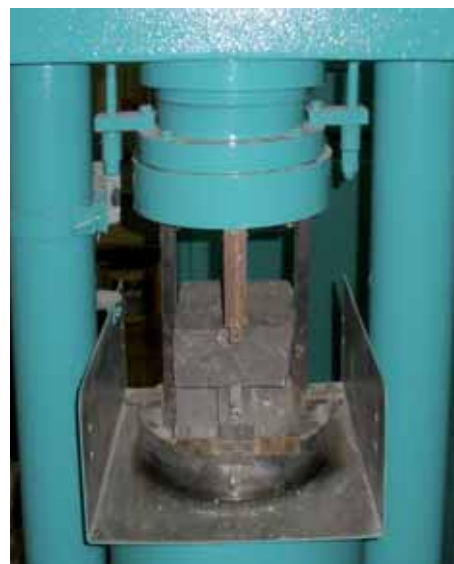
BETON ÚTBURKOLÓ KŐ HASÍTÓ VIZSGÁLATA
