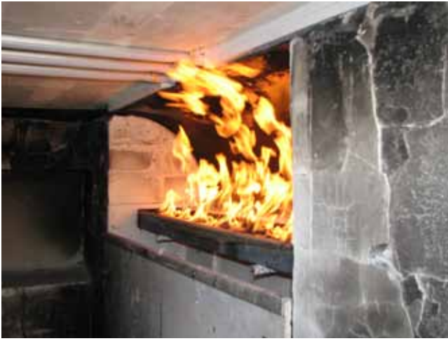
7. ÁBRA: VILÁGÍTÓTEST GYÚJTÁSVESZÉLYESSÉG-VIZSGÁLATA
