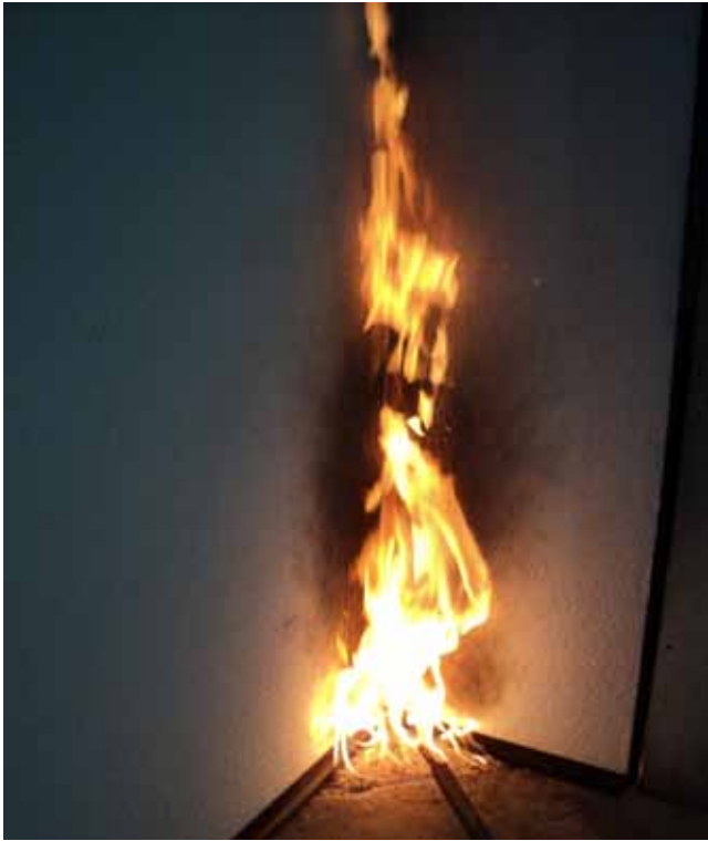
2. ÁBRA: HOMLOKZATI HŐSZIGETELŐ RENDSZER MSZ EN 13823 SZERINTI VIZSGÁLATA
