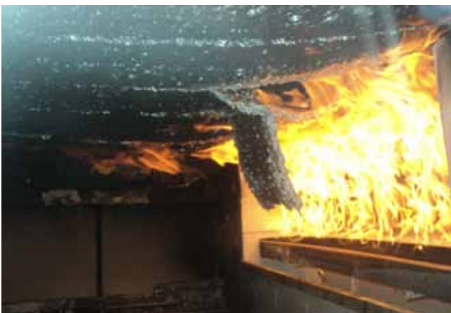
8. ÁBRA: FEJ FELETT ALKALMAZOTT BURKOLAT GYÚJTÁSVESZÉLYESSÉG-VIZSGÁLATA
