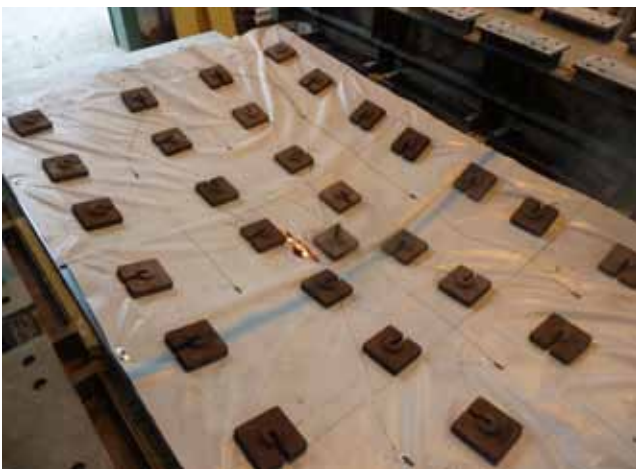
4. ÁBRA: TETŐFÖDÉM TÉRELHATÁROLÓ SZERKEZET TŰZÁLLÓSÁGI VIZSGÁLATA. A SZERKEZETEN JELENTŐS LEHAJLÁS MELLETT LÁNGÁTTÖRÉS IS MEGFIGYELHETŐ
