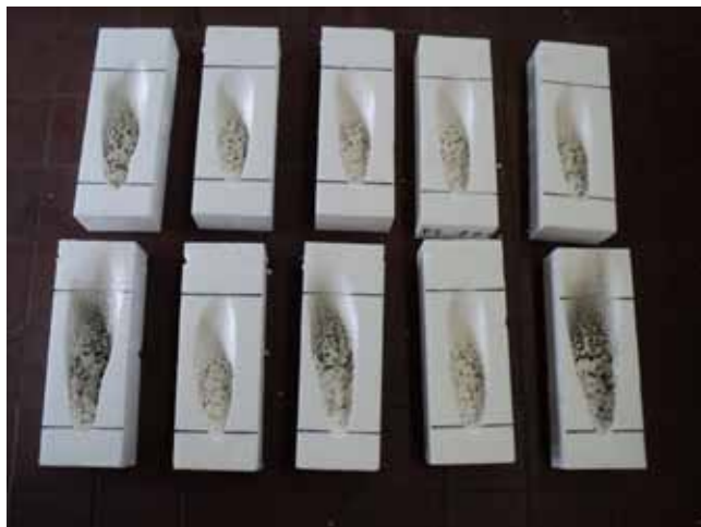
I. ÁBRA: POLISZTIROL PRÓBATESTEK MSZ EN ISO 11925-2 SZERINTI VIZSGÁLAT UTÁN
