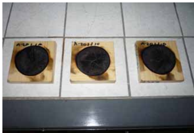
6. ÁBRA: ÉGÉSKÉSLELTETŐSZERREL KEZELT FAANYAGBÓL KIMUNKÁLT PRÓBATEST MSZ 9607-1 SZABVÁNY SZERINTI VIZSGÁLAT UTÁN
