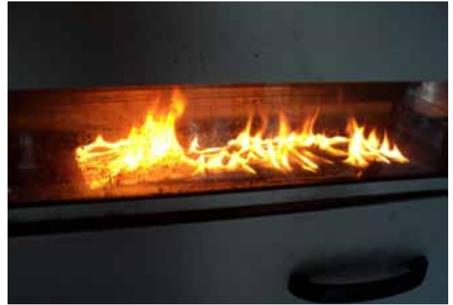
9. ÁBRA: PADLÓBURKOLAT VIZSGÁLATA (LÁNGTERJEDÉS) SUGÁRZÓ HŐ HATÁSÁRA AZ MSZ EN ISO 9239-1 SZERINT
