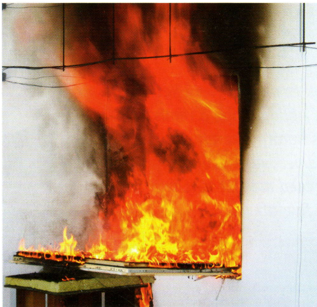
EPS-rendszer tűzvizsgálata. A panelprogram kapcsán felértékelődik az ÉMI tudása
